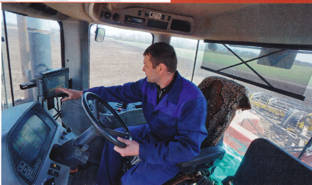
На современном тракторе КИП расположены перед трактористом, сбоку, сверху, а иногда и сзади.
