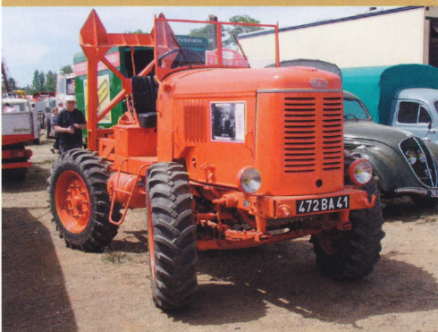
Трактор Latil TL10 H14 может тянуть прицеп с хлыстами весом до 15 т со скоростью до 35 км/ч.
