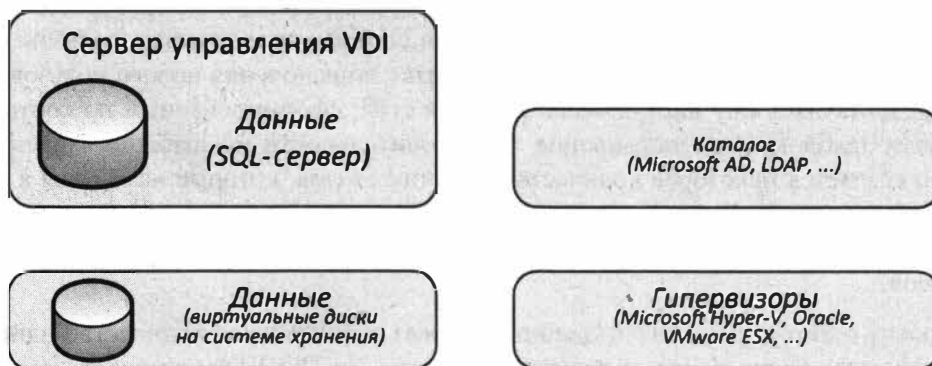
Рис. 8.3. Логическая структура VDI-решения
