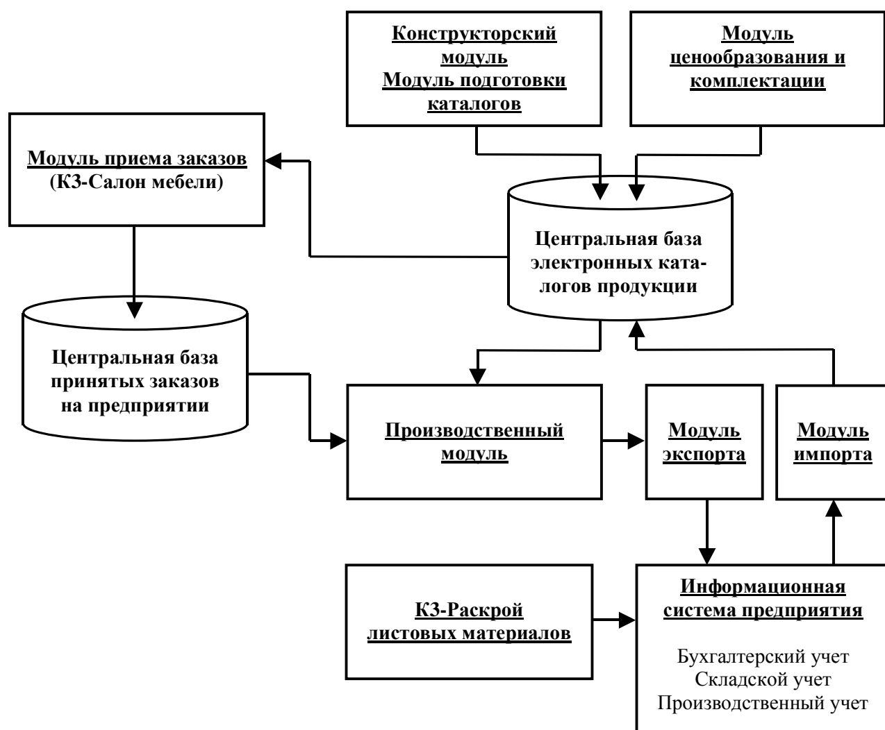
Рис. 138 Общая структурная схема программного комплекса КЗ-Мебельное предприятие
